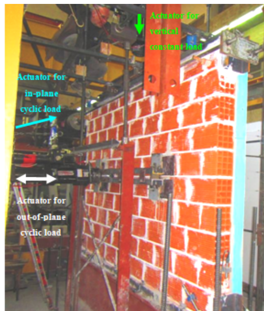
3: Ένα δοκίμιο τοίχου με επικολημένη θερμομονωτική πρόσοψη προσαρμοσμένο στην σύνθετη 3-D πειραματική διάταξη για την εύρεση της φέρουσας ικανότητάς του σε σεισμικού τύπου φορτίσεις. Εργαστήριο Πειραματικής Αντοχής των Υλικών και των Κατασκευών, Αριστοτέλειο Πανεπιστήμιο
