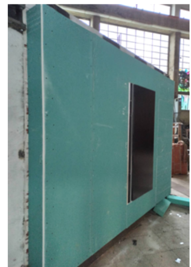
4: Προετοιμασία ενός δοκιμίου τοιχοπλήρωσης με αεριζόμενη θερμομονωτική πρόσοψη για την προσαρμογή του στην σύνθετη 3-D πειραματική διάταξη. Η δοκιμή στοχεύει στην εύρεση της φέρουσας ικανότητάς του σε σεισμικού τύπου φορτίσεις. Εργαστήριο Πειραματικής Αντοχής των Υλικών και των Κατασκευών, Αριστοτέλειο Πανεπιστήμιο
