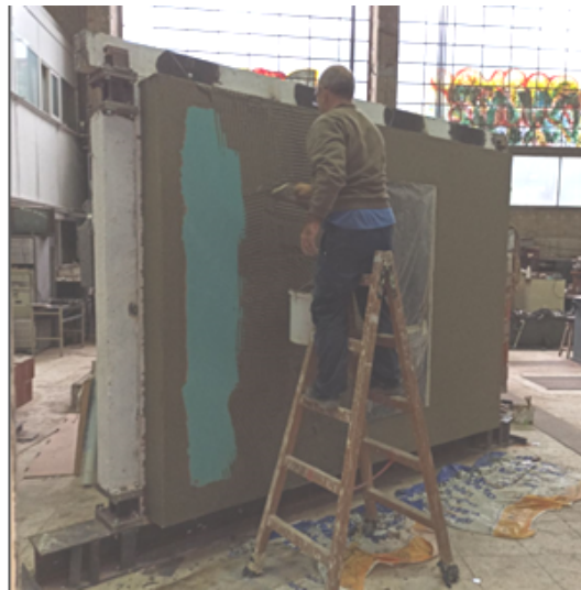
1: Η προετοιμασία ενός δοκιμίου τοιχοπλήρωσης με θερμομονωτική πρόσοψη για την εύρεση της φέρουσας ικανότητάς του σε σεισμικού τύπου φορτίσεις. Εργαστήριο Πειραματικής Αντοχής των Υλικών και των Κατασκευών, Αριστοτέλειο Πανεπιστήμιο
